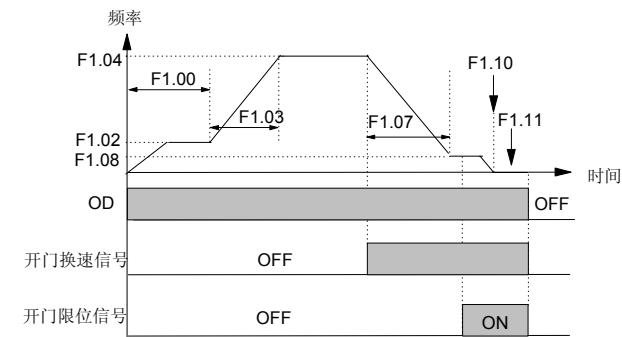
图 6-4 速度控制开门运行曲线示意图
