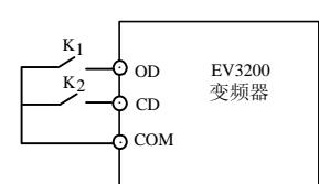
图6-1 门机端子控制逻辑
