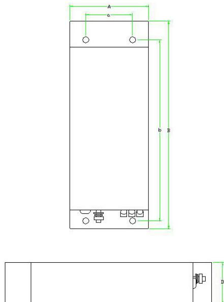
图1 EMI 滤波器尺寸图
