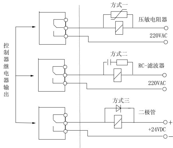
图3-10 继电器、接触器及电磁制动器要求
