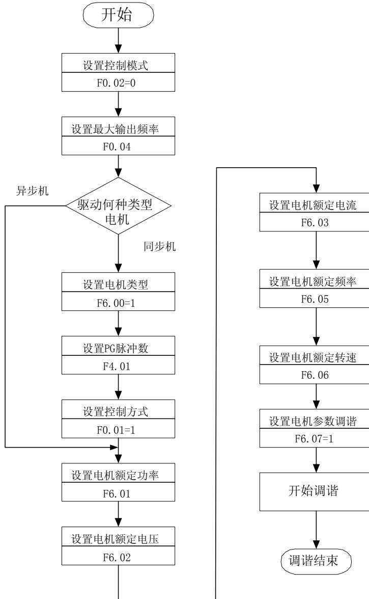
图7-1 电动机调谐过程流程图
