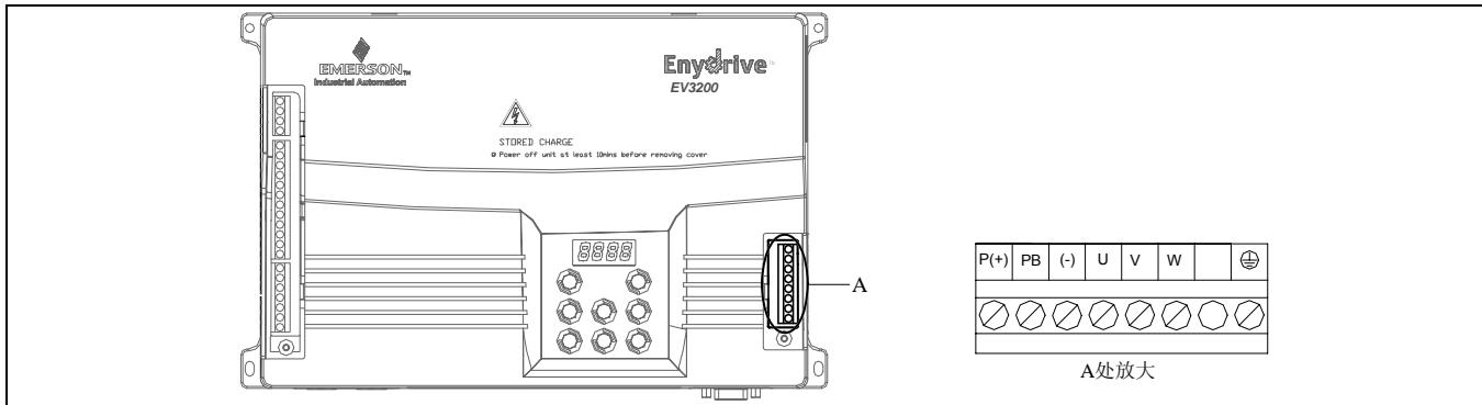
图3-2 输出电源端子
