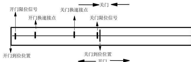
图 6-3 速度控制各控制接点安装示意图
