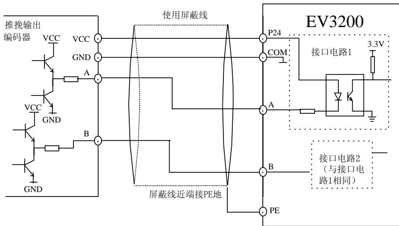
图3-8 推挽输出型脉冲编码器接线图
