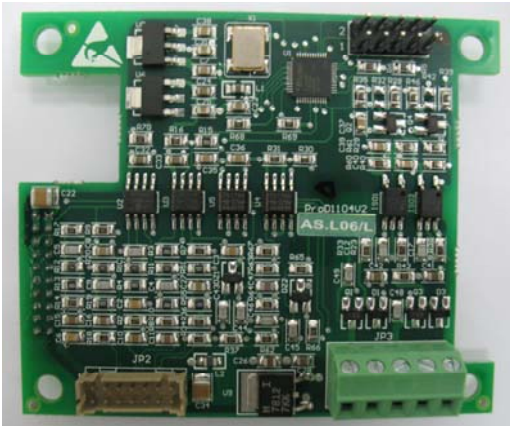
图 4.28 Endat 绝对值型 PG 卡端子排列
