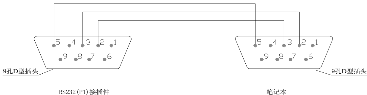
图 6.43 接口补充说明图 (RS232 监控端口连接电脑示意图)
