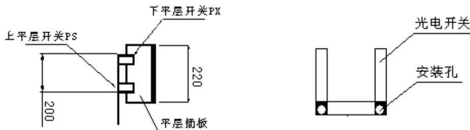
图 8.8 平层开关安装标准
